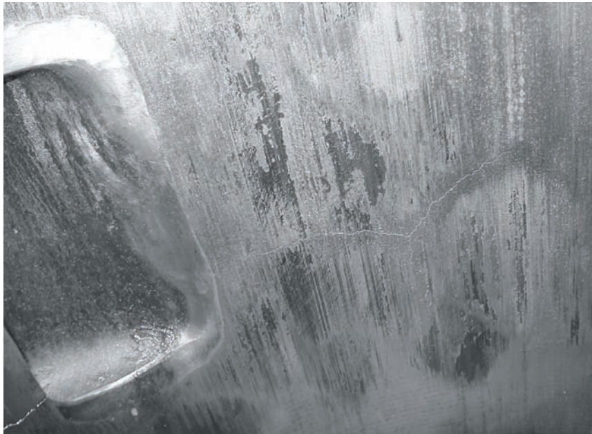
Rys. 4. Widok powierzchni wewnętrznej patologicznie zużytej i uszkodzonej tulei cylindrowej silnika 6RLB66 w okolicy okien dolotowych
